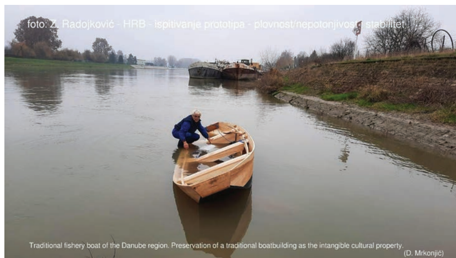
Slika 7: Ispitivanje prototipa – plovnost, nepotonjivost stabilitet.
